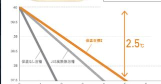
湯温定低下しにくいので、追い焚き回数が減らせます。保温浴槽なしと比べて、年間光熱費を約4,300円も節約できます。
