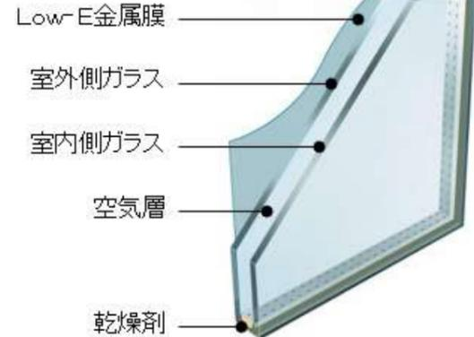
「Low-E複層ガラス」はガラスに金属膜をコーティングした複層ガラスで、一般的な複層ガラスより断熱・遮熱性に特に優れています。
